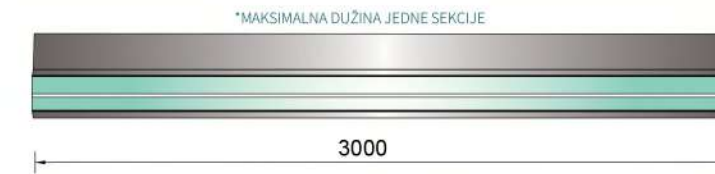
(SLIKA 2.3) MAKSIMALNA DIMENZIJA KONZOLNOG NOSAČA
